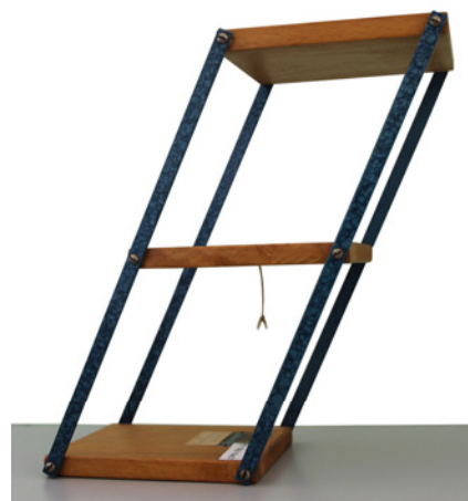
Fig. 9 Dispositivo de laboratório escolar, cuja forma se pode variar. Há estabilidade sempre que o fio vertical caia na base de sustentação do objeto.
