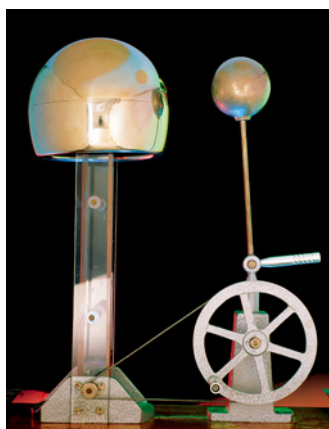
Fig. 23 Modelo de gerador de Van de Graaff e esquema de funcionamento.
