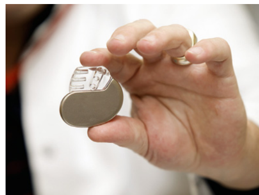
Fig. 42 Um pacemaker utiliza um circuito RC.
