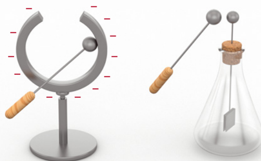
Fig. 19 A superfície interior da taça não está eletrizada, pelo que uma esfera metálica que toque nessa superfície não fica eletrizada.
