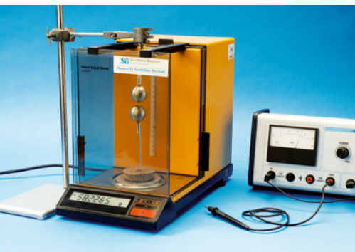
Fig. 7 Dispositivo para medir a força elétrica entre duas pequenas esferas com cargas simétricas.
