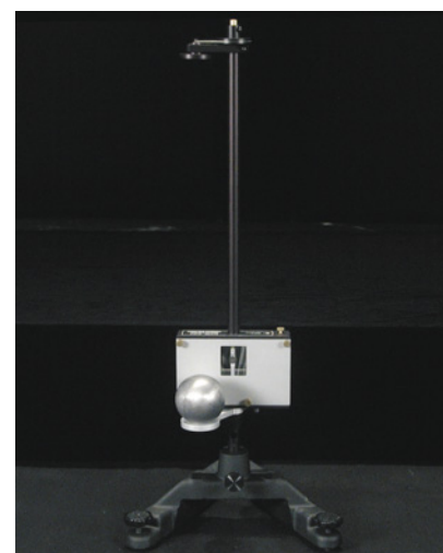
Fig. 12 Dispositivo moderno para realizar a experiência de Cavendish.
