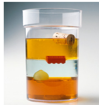
Fig. 45 Corpos a flutuar em líquidos imiscíveis: o corpo vermelho sofre impulsão por parte de dois líquidos.
