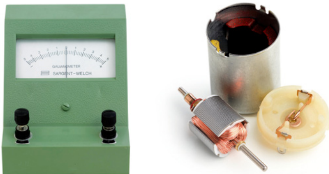
Fig. 3 As forças magnéticas fazem mover os ponteiros de certos aparelhos elétricos de medida e provocam rotações em motores elétricos.
