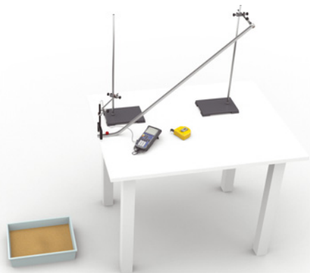
Fig. 75 Montagem experimental para o estudo do lançamento horizontal.
