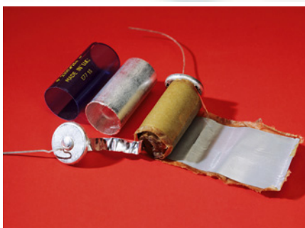
Fig. 41 Condensadores de diferentes tamanhos e capacidades (em cima) e interior de um condensador (em baixo).
