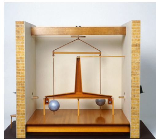
Fig. 10 Réplica do dispositivo usado por Henry Cavendish para determinar o valor da constante de gravitação universal, G .
