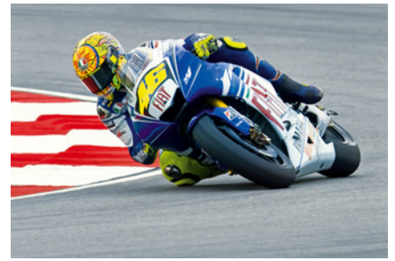
Fig. 59 O condutor inclina-se para que a força normal contribua para aumentar a componente centrípeta da força resultante.
