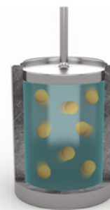
Fig. 12 Num gás, a pressão nas paredes do recipiente deve-se às colisões das moléculas com essas superfícies.
