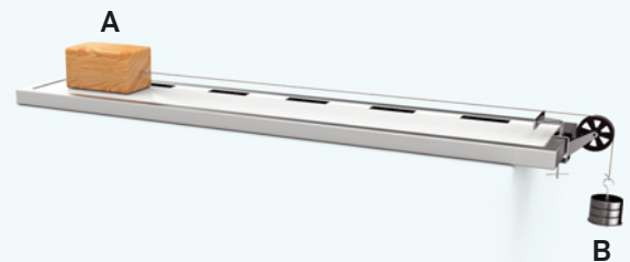
Fig. 76 Os dois corpos, ligados por um fio, estão em repouso devido à força de atrito.
