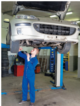
Fig. 36 Elevador hidráulico de automóveis e respetivo esquema.
