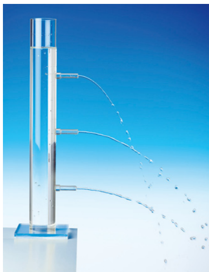
Fig. 16 As forças de pressão do líquido sobre o recipiente são perpendiculares às suas paredes, pelo que a água sai horizontalmente pelos orifícios.
