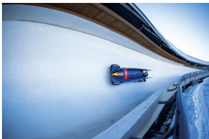
Fig. 56 Bobsled: corrida em pistas geladas, a grandes velocidades, cuja segurança é facilitada pela inclinação do plano das curvas.
