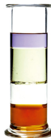
Fig. 6 Líquidos imiscíveis: a densidade relativa aumenta sucessivamente do líquido superior para o líquido inferior.
