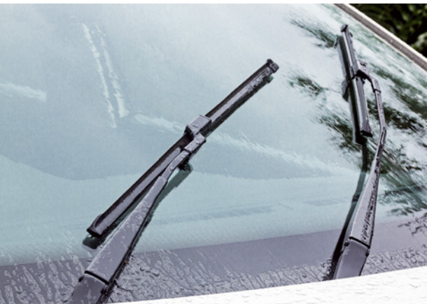
Fig. 45 O limpador para-brisas de um automóvel é controlado por um circuito RC : cada velocidade corresponde a um valor de R .
