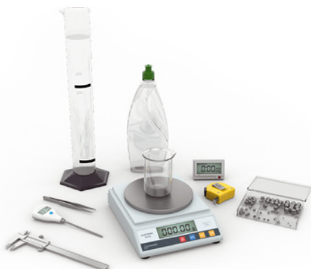
Fig. 53 Material para a determinação do coeficiente de viscosidade de um líquido.
