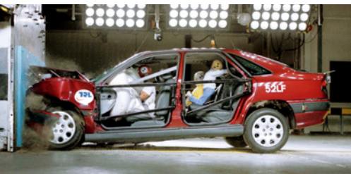
Fig. 13 Teste de colisão: as forças na colisão do automóvel com o obstáculo atuam num intervalo de tempo muito curto e têm intensidade variável, que pode ser muito elevada.
