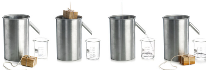
Fig. 41 Procedimento experimental para medir a intensidade da impulsão.
