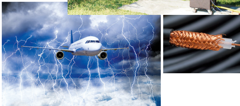
Fig. 25 Réplica da experiência de Faraday, avião sob descarga elétrica e rede metálica num cabo coaxial: no interior das «gaiolas» o campo elétrico é nulo.
